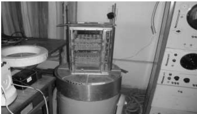
**Рис. 1. Лабораторная вибрационная установка для испытания плат**
