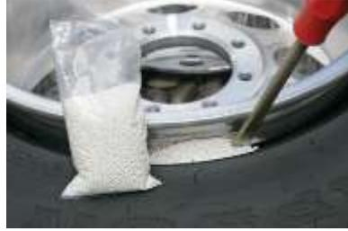
**Рис. 2. Технологія autobalance для автомобільних коліс Magnum**
