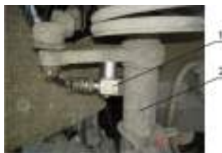
Рис. 3 Схема встановлення вібрдатчика на стійці передньої підвіски автомобіля ВАЗ 2110: 1 – вібрдатчик; 2 – стійка передньої
